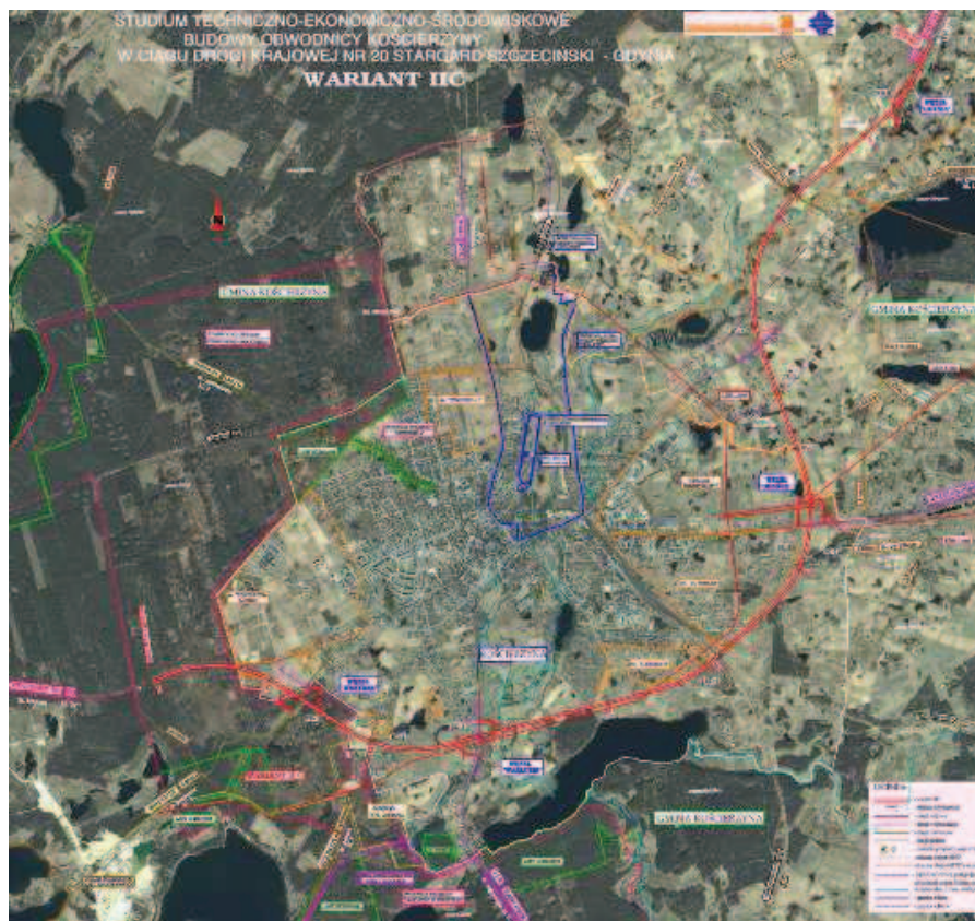
Rysunek 64. Planowany przebieg obwodnicy Kościerzyny (źródło: GDDKiA)
